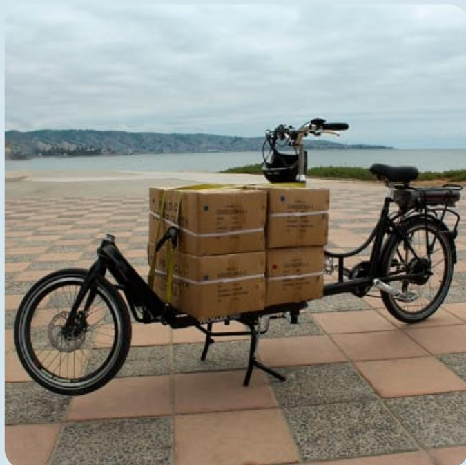
La bicicleta E-Cargo, optimiza la relación entre carga y tipo de transporte, soporta una carga de hasta 150 kilos y puede alcanzar hasta 60 kilómetros de autonomía, tras un tiempo de carga de 5-6 horas, y una velocidad de hasta 25 km/hora. Si bien ese modelo es el de valor más elevado, hay una opción más económica que incluye dos parrillas que sostienen hasta 25 kilos cada una y alcanza una autonomía asistida de 50 kilómetros.
